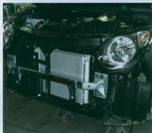
**4** Zoom sur deux exemples des structures sur-mesure en acier fabriquées par Towtal en Angleterre : invisibles, elles se posent en une journée, derrière le bouclier avant en étant boulonnées aux longerons du châssis.
