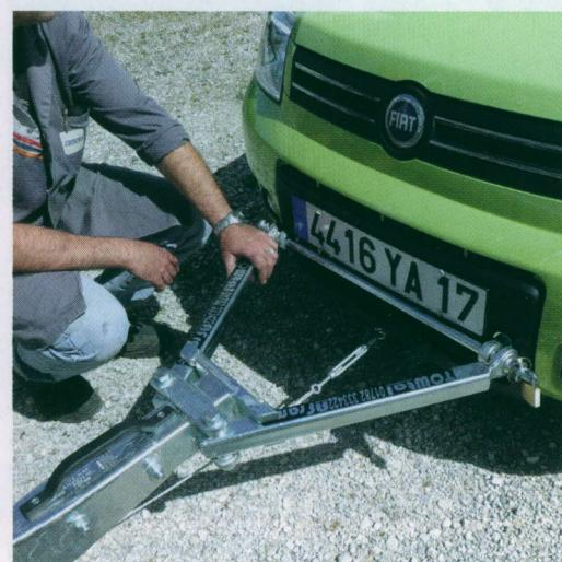
**3** Très facile à utiliser, le système Towtal est constitué d'une barre passant dans les 2 alésages vissés derrière le pare-choc directement au châssis avec des pièces spécifiques au véhicule. On distingue bien au centre du V, sous la plaque d'immatriculation, le crochet du câble de freinage de la « remorque ».
